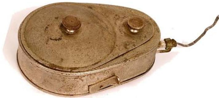
Un levier d'arrêt dont une extrémité sort de la plaque *I* en  $a^1$  et l'autre s'allonge à l'intérieur en *a* en commande le mouvement; car en déplaçant le bout  $a^1$  à droite, le levier pivote sur  $a_0$ , le bout *a* se dégage des ailes du modérateur et le mouvement se met en marche. Au contraire en le déplaçant à gauche, le bout *a* bute contre les ailes du modérateur et arrête le mouvement.
