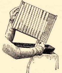
La durée d'exposition des images, par suite leur luminosité est considérablement augmentée puisqu'elle est, dans le mirographe de 3/4 pour 1/4 d'escamotage, alors que dans les autres systèmes, elle est de 2/3 pour 1/3 d'escamotage, parfois même de moitié d'escamotage.
